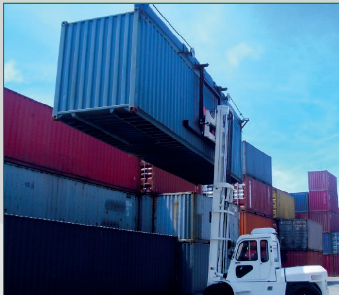
TSS - Top Spreader - 1 função hidráulica
